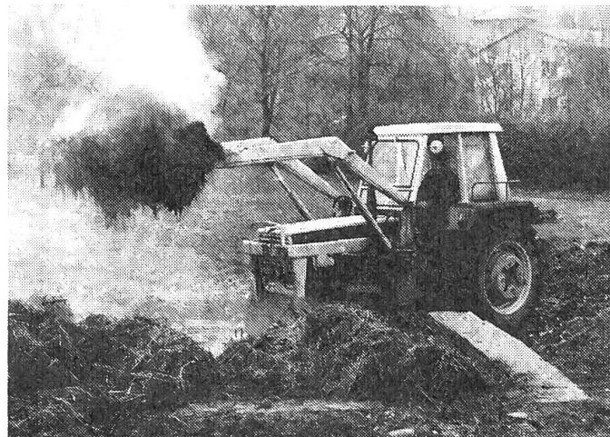
Der Frontlader am Traktor – ein Tausendsassa, der leider noch viel zuwenig Verwendung findet. Primär als Ladegerät entwickelt, ist er heute ein das ganze Jahr hindurch universell verwendbares Gerät, das im Vergleich zu seiner Leistung zudem äusserst preiswert ist. Eignet sich besonders auch im Einsatz in Maschinenringen.
