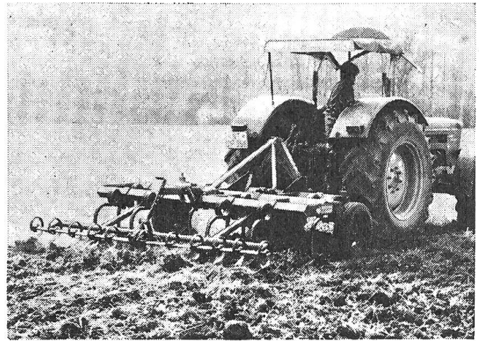
Abb. 1: Schwergrubber mit 70 cm Rahmenhöhe, höhenverstellbarem Kuppeldreieck, seitlich verschiebbaren Spiralfederzinken und nachgeschalteten Federzinken-Zustreichern zum Einebnen und Krümeln des Bodens.
