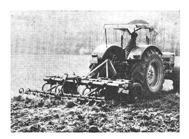
Abb. 1: Schwergrubber mit 70 cm Rahmenhöhe, höhenverstellbarem Kuppeldreieck, seitlich verschiebbaren Spiralfederzinken und nachgeschalteten Federzinken-Zustreichern zum Einebnen und Krümeln des Bodens.
