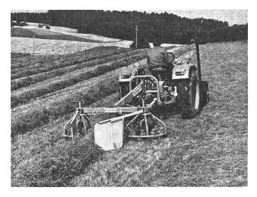
Abb. 2: Kombikreisler «Kemper-Heuromat» beim Schwadenziehen.
