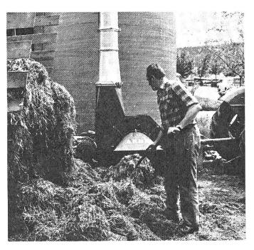
Abb. 5: Antrieb des Gebläses wahlweise mit aufgebautem Elektromotor oder mit Traktorzapfwelle. Bei Traktorantrieb bleibt der Elektromotor aufgebaut. Die Zapfwelle, um 90° abgewinkelt, ist in jeder Situation für den Traktor gut zugänglich.
