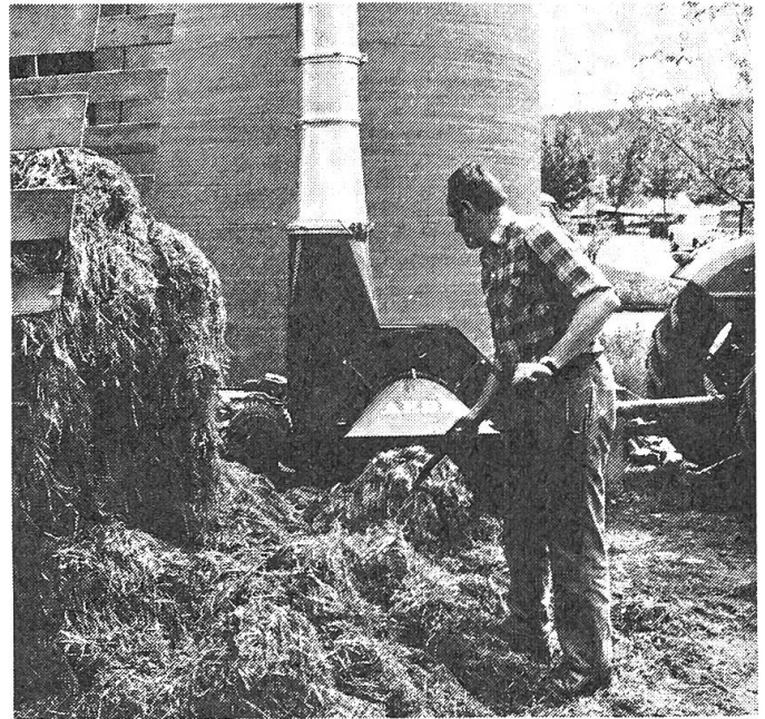
Abb. 5: Antrieb des Gebläses wahlweise mit aufgebautem Elektromotor oder mit Traktorzapfwelle. Bei Traktorantrieb bleibt der Elektromotor aufgebaut. Die Zapfwelle, um 90° abgewinkelt, ist in jeder Situation für den Traktor gut zugänglich.
