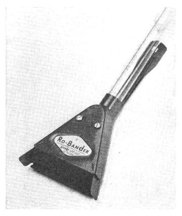
Abb. 3: Fischschwanzförmiger Verteiler.
