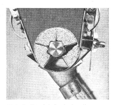
Abb. 2: Deutlich sind die einzelnen Kammern zu sehen, die der untenliegenden Auslauföffnung das Granulat zuführen und gleichzeitig beim Halten absperren.
