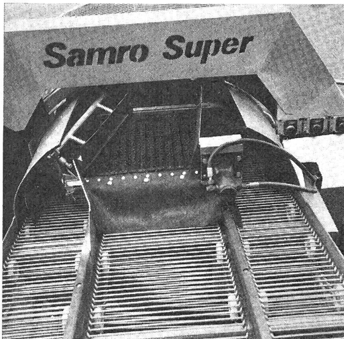
Abb. 2: Blick auf Noppenbänder und Verleseband, die mittels Hydromotoren angetrieben werden.
