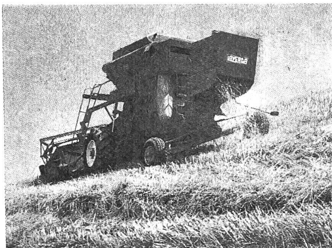
Abb. 8: Mähdrescher «Laverda»; mit einer speziellen elektrohydraulischen Vorrichtung wird der Dreschkasten stets in waagrechter Position gehalten. Die Hangtauglichkeit des Mähdreschers wird dadurch wesentlich erhöht.
