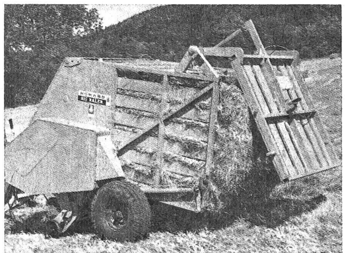
Abb. 10: System Big-Bale; die Ballen haben eine Grösse von 1,5 x 1,5 x 2,6 m.
