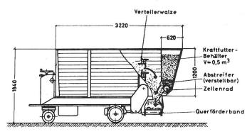
Abb. 3: Vorgang bei der Vermischung des Kraftfutters mit dem Grundfutter in einem Fütterungswagen mit Kraftfutter-Dosiergerät (Foto Weihenstephan).
