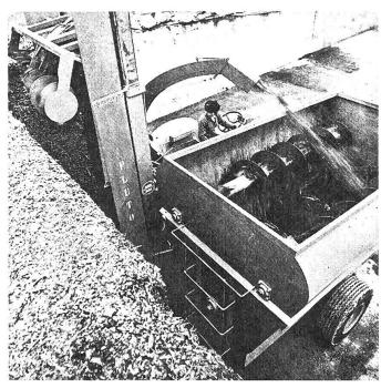
Abb. 4: Fütterungsmischwagen mit drei Mischschnecken. Bei dieser Art der Befüllung mit einer Flachsilofräse sind sehr breite Flachsilos notwendig.
