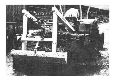
Abb. 2: Neues Gerät für die Entnahme im Flachsilo mit anschliessender Fütterung durch das Querförderband. Preis Fr. 12 000.—.
