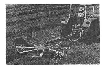
äusseren Enden mit breiten, elastisch weichgefederten Zinken bestückten Rechenarme in eine Kreisumlaufbahn. Diese wird durch eine Kurvenbahn so gesteuert, dass jeder Rechenarm seine aufgenommene Futterportion schonend über den Boden dem Schwadformer zuführt und sie dann durch Hochschwenken ablegt.
