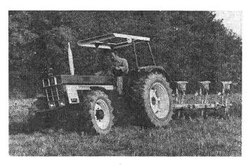
Der neue IHC-Traktor, Modell 844 (75 DIN-PS) mit Fahrerschutz-Verdeck.
