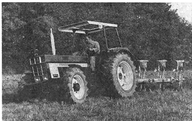
Der neue IHC-Traktor, Modell 844 (75 DIN-PS) mit Fahrerschutz-Verdeck.
