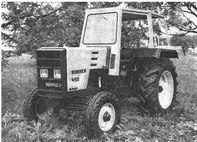
Abb. 2: Bührer 455 — 55 PS Traktor mit Ueberrollbügel, Dach und Frontscheibe.
