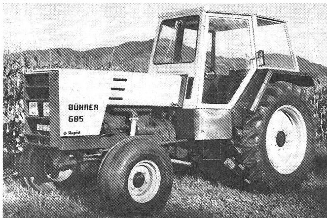
Abb. 1: 1 Repräsentant der neuen Typenreihe. Bührer 685 — 85 PS Traktor mit vollausgebaute Sicherheitskabine.
