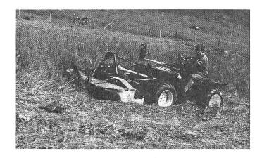
Mit der zweiten Generation wurde versucht, die erwähnten Nachteile auszumerzen. Verschiedene Firmen entwickelten leichte 2-Achs-Fahrzeuge, welche mit Finger- oder Doppelmesserbalken und teilweise mit 4-Rad-Antrieb versehen waren. Relativ schwache Motoren und die Eigenschaften der Messerbalken begrenzten aber deren Einsatz resp. deren Leistung in extrem steilem Gelände.
