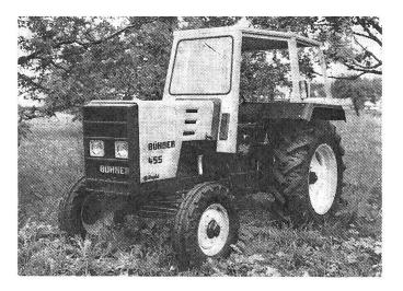
Abb. 2: Bührer 455 — 55 PS Traktor mit Ueberrollbügel, Dach und Frontscheibe.
