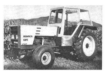
Abb. 1: 1 Repräsentant der neuen Typenreihe. Bührer 685 – 85 PS Traktor mit vollausgebauter Sicherheitskabine.
