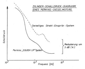
Die Zeichnung zeigt das Ergebnis einer «Fourier-Analyse» des Zylinderdrucks im Verhältnis zur Frequenz. Das typische «Diesel-Klopfen», welches auf der Zeichnung durch das Ansteigen der gestrichelten Linie oberhalb von 10³ Hz dargestellt wird, ist auf die hohen Verbrennungsfrequenzen des Direkt-Einspritz-Systems zurückzuführen. Diese Frequenzen werden beim Perkins-«Squish Lip»-System stark reduziert, was auf einen «weicheren» Druckverlauf dieses Verbrennungssystems zurückzuführen ist.
