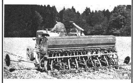
Beidseitiger Antrieb durch Winkelgetriebe, Saatauslauf nach vorne, zentrale Druckregulierung, Pendelrührwerk usw.
