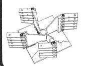
Der speziell ausgebildete Flügel mit den auswechselbaren Flügel (Schläger) zerkleinert und fördert das zu verarbeitende Produkt.
