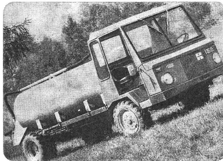
Bestechend ist der grosse Einsatzbereich des Muli. Auch mit Druck- und Pumpfass steht er bei der Flüssigdüngerausbringung bewährt im Einsatz. Als Antriebsquelle dient der bärenstarke Perkins -3-Zylinder-Dieselmotor mit Direkteinspritzung (46 DIN-PS bei 2200 U/min). Laufraue und niedriger Treibstoffverbrauch werden verwöhnsten Ansprüchen gerecht.
