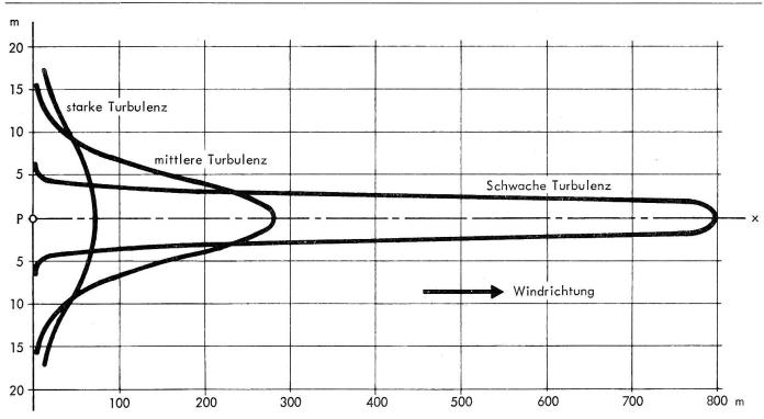
Abb. 8: Ungefährer Verlauf der Geruchskonzentration (Geruchsschwellen) auf dem Niveau 2 m über Terrain bei konstanter Windgeschwindigkeit aber unterschiedlicher Turbulenz.
