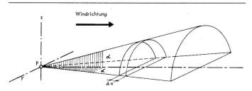
Abb. 7: Schematische Darstellung der Ausbreitung eines Geruchsschwadens aus einer Punktquelle P.
