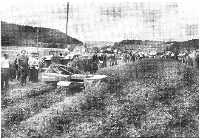
Abb. 3: Kreiselmähwerk mit Aufbereitungseinrichtung (Stahlwalzen).
