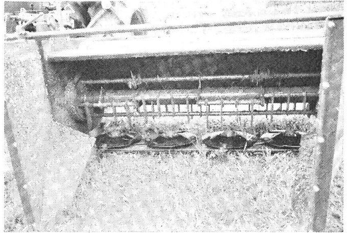
Abb. 4: Aufbereitungseinrichtung mit 2 rotierenden Schlegelwellen über Scheibenmähwerk.
