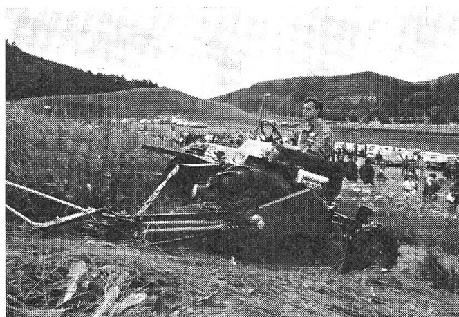
Abb. 6: Zweiachsmäher mit mechanisch angetriebenem Front-Doppelmesserbalken.
