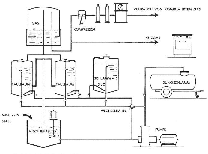
Abb. 2 SCHEMA EINER BIOGAS - ANLAGE
