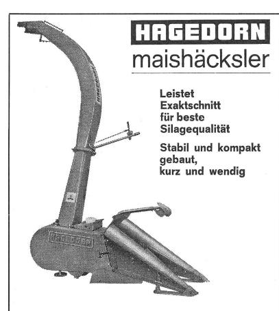
Die Hochleistungsmaschine mit dem bestens bewährten Schneid- und Zuführsystem (Kreiseleinzug-)Schneidtrommel mit 9 Messern und eingebauter Überholkupplung – serienmäßige Messerschleifeinrichtung.
