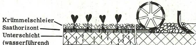
Die RAU-KOMBINATION mit SW-Stegwalzenkrümller bereitet stets einen idealen Saathorizont, mit wasserführender Unterschicht und einem obenaufliegendem Krümmelschleier.
