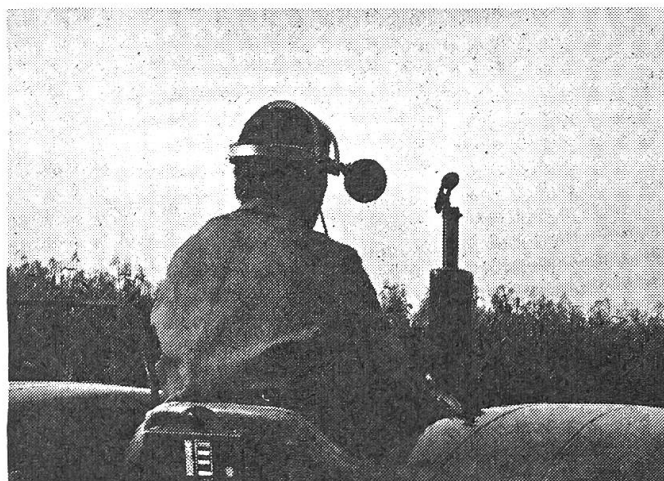
Abb. 2: Lärmmessungen am Ohr des Fahrers mit einer Mikrofon-Haltevorrichtung (Foto-FAT).
