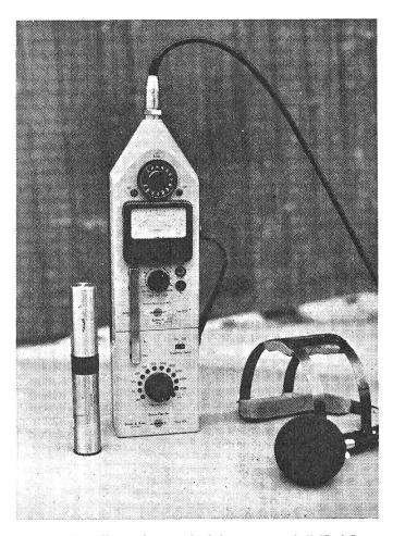
Abb. 3: Schallpegelmesseinrichtung speziell für Lärmmessungen am Ohr des Bedienungsmannes von landwirtschaftlichen Maschinen und Fahrzeugen. (Foto-FAT)
