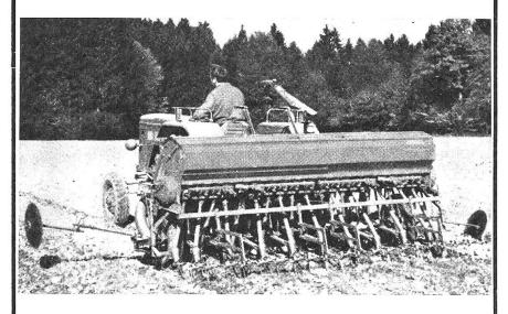
Beidseitiger Antrieb durch Winkelgetriebe, Saatauslauf nach vorne, zentrale Druckregulierung, Pendelrührwerk usw.
