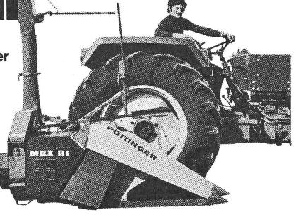
Silomais gewinnt durch seine wirtschaftlichen Vorteile immer mehr an Bedeutung. Pöttinger Maishäcksler vereinigen alle Vorteile für die rationelle und saubere Ernte von Silomais. Dank Vorpressung und Scheibenrad, 4-mm-Exaktschnitt für Supersilage. Jedes Maiskorn wird aufgeschlagen — daher optimale Ausnützung des Silo-
