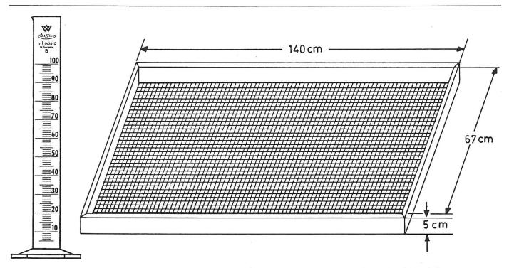
Abb. 7: Prüfschale «Borimer Klatsche» und Messzylinder (Fertigungsmasse nach Rechenbeispiel).
