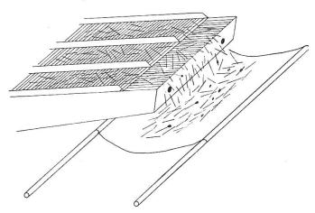
Abb. 3: Prüftuch zur Bestimmung der Dreschwerkverluste.
