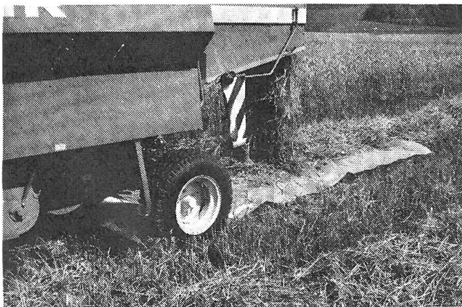
Abb. 5: Dreschwerkverlustbestimmung bei Mähdrescherversuchen an der FAT.
