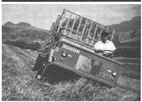
Ein Mehrzweckfahrzeug, wie man es braucht im modernen Betrieb. Mit der Futteraufnahme vor den Vorderrädern: zum Eingrasen, Silieren, Heuen, Emden. Mit dem separaten Kratzboden zum Mistzetten. Mit Pump- oder Vakuum-Druck-Fass. Geeignet für alle Arbeiten mit der Seilwinde. Und für alle Transporte bis 2,5 Tonnen Nutzlast. Wirklich tiptop, auch sein starker 40-PS-Perkins-Dieselmotor. Der Ladetraktor für Sie!
