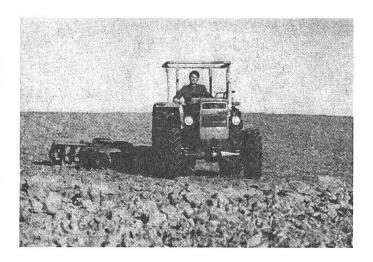
Standardausrüstung: Bereifung vorn 7.50–16 und hinten 12.40/11–32.
