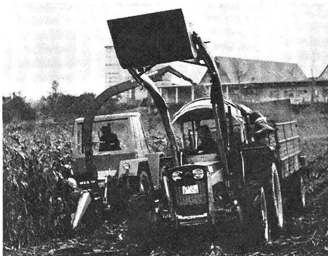
Allrad-Grosstraktor KRAMER mit Zweiwege-System. Eine zukunftsweisende Kombination ist der Allrad-Gross-Schlepper mit mehrreihigem Maishäcksler. In Schubfahrt wird der Traktor zu einer Selbstfahrmaschine von unübertroffener Manövrierfähigkeit.
