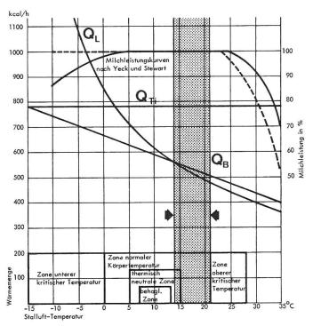
Abb. 2: Verschiedene Einflussfaktoren bei der Bestimmung der möglichen Stallufttemperatur im Milchviehstall.
