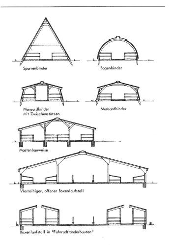
Abb. 4: Mögliche Konsktruktionslösungen für Einfachbauten.
