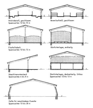
Abb. 5: Bauformen in Starrahmenbauweise.
