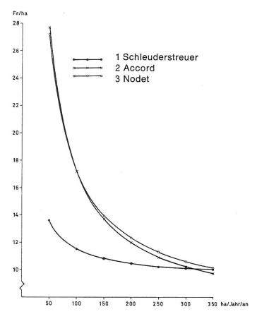
Abb. 8: Arbeits- und Maschinenkosten (Selbstkosten) des Düngerstreuers in Abhängigkeit der Streuarten und der jährlichen Auslastung.
