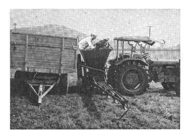
Abb. 4: Auffüllen des Düngers aus einem Wagen (Düngerstreuer Nodet in Arbeitsstellung).
