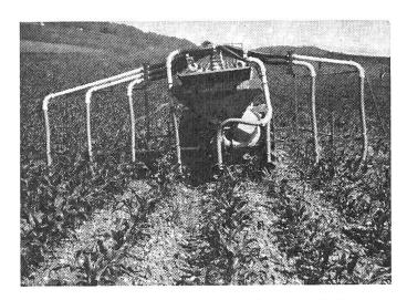
Abb. 7: Düngerstreuer Accord mit einer Reihenvorrichtung für die Unterblattdüngung (Maisfeld).
