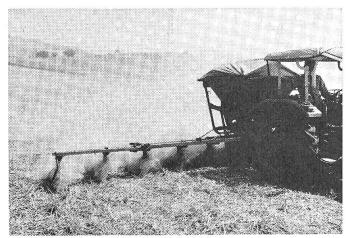
Abb. 6: Düngerstreuer Nodet beim Ausbringen von Thomasmehl. Infolge Staubentwicklung und Brückenbildung befriedigte die Arbeit nicht.
