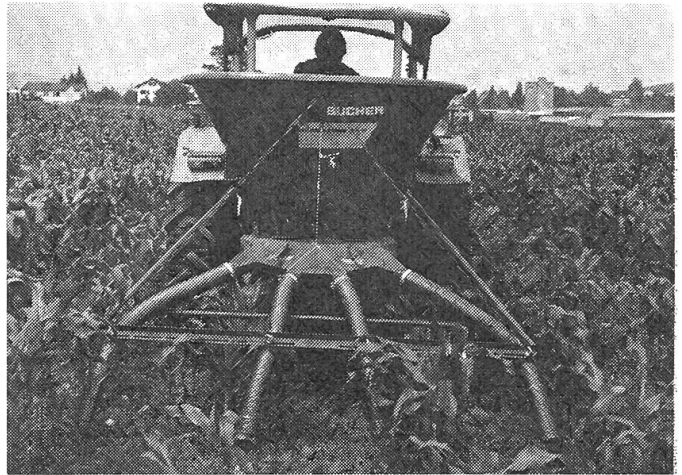
Abb. 3 Zweiseiben-Schleuderstreuer Amazone mit vierreihiger Streuvorrichtung. Die Streuschläuche sind provisorisch befestigt.
