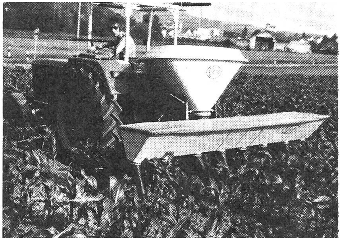
Abb. 4a: Pendelstreuer Vicon mit vierreihiger Streuvorrichtung.
