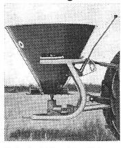
Oelbadgetriebe, 2 Ausläufe. Sofort betriebs-Streuweite bis 14 m ab Fr. 896.— bereite Aufstellung.
