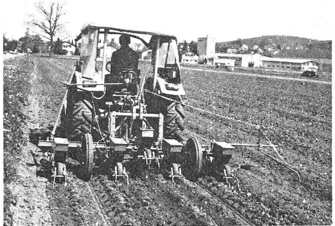
Abb. 8a: Hassia-Exakta (Vergleichsmaschine). Das mittlere Sägerät ist angehoben, der Antrieb ausgeschaltet.
