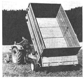
Abb. 2: Audureau-Kipper in Ganzstahl-Konstruktion.
