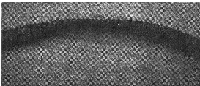
Abb. 5: Ein gequetschter Saugschlauch vermindert die Leistung der Pumpe. Fotos: W. Bühler
