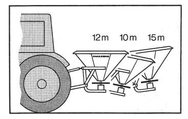
Der Gebrauchsanleitung folgend, lassen sich durch Strecken und Kürzen des Oberlenkers verschiedene Arbeitsbreiten zuverlässig einstellen (hier bei Kalkammonsalpeter). chenden Daten sind in der überzeugenden, haltbaren Streutabelle genau und nach den verschiedenen Düngersorten getrennt angegeben. Dabei garantiert das Werk exakte Verteilung.
