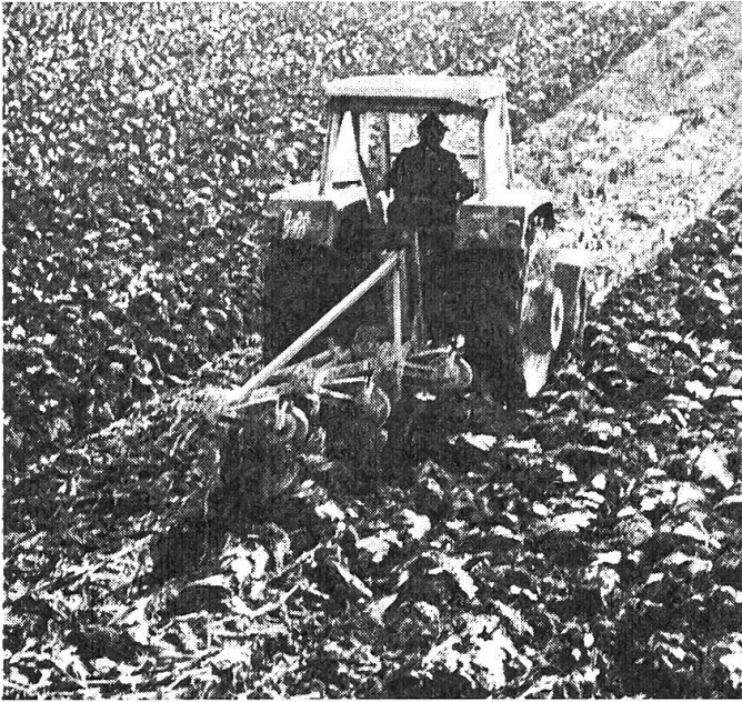
Abb. 7: Man darf auch einem 75 PS-Traktor nicht mehr als drei Schare zumuten, wenn die Bodenverhältnisse es verlangen, sonst gibt es einfach zu viel Schlupf und die Arbeit wird unwirtschaftlich.
