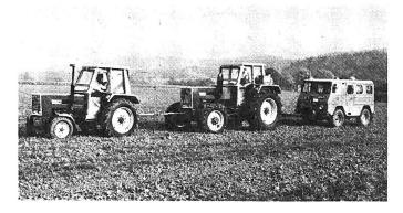
Abb. 3: Prüfung von Schlupfunterschieden zwischen Gürtel- und Diagonalreifen.
