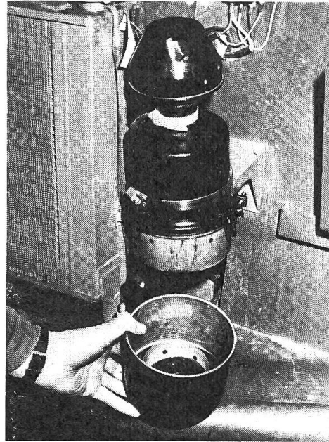
Abb. 2: Der richtige Ölstand und reines Öl ge- währleisten auch einwandfreie Ansaugluft (siehe Öl- standsmarke!).
