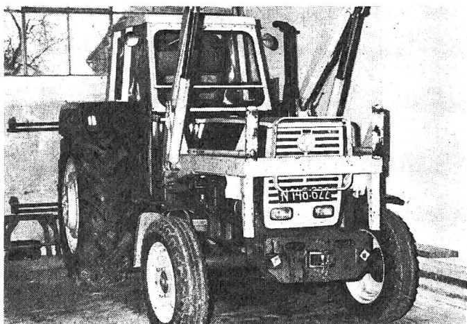
Abb. 6: Zusätzliche Belastung der Hinterräder über die Regelhydraulik bei schweren Zugarbeiten entlastet die Vorderachse. Daher sind die vorderen Ballastgewichte schon aus diesem Grunde sehr wichtig geworden.
