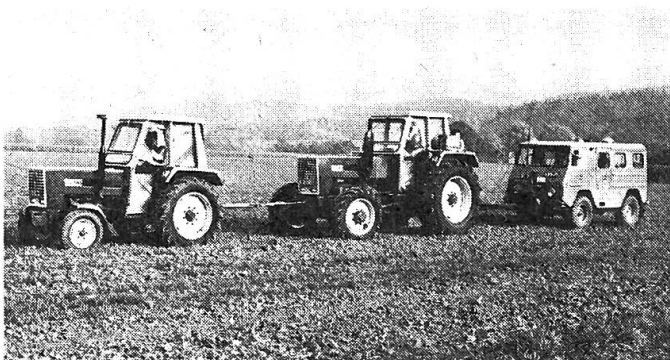
Abb. 3: Prüfung von Schlupfunterschieden zwischen Gürtel- und Diagonalreifen.
