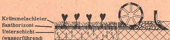
Die RAU-KOMBINATION mit SW-Stegwalzenkrümller bereitet stets einen idealen Saathorizont, mit wasserführender Unterschicht und einem obenaufliegendem Krümmelschleier.
