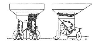
Abb. 5: Legeautomat mit Greiferrad
