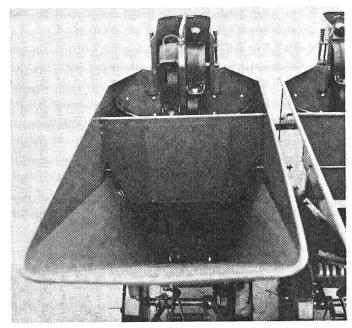
Abb. 11: Saatgutbehälter und Doppelbechergurten des Legeautomaten Gruse
