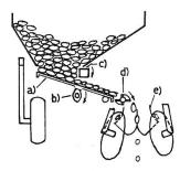
Abb. 4: Legeautomat mit Schöpfwalze und Gurtenablage
