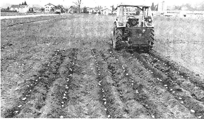
Abb. 7: Legeautomat Agrostroj beim Ablagetest
