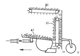
Abb. 3: Legeautomat mit Vibrationstisch und Gabelkette (System Besson) a) Vibrationstisch
