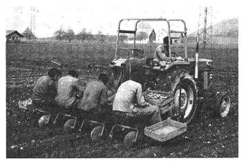
Abb. 6: vierreihige Handlegemaschine mit Vorratstellern und Fallrohren.
