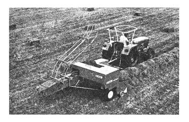
Die Type HD 300 ist auf eine Ballenleistung bis 14 t/h ausgelegt. Sie hat ein Eigengewicht von 960 kg. Die neue Presse hat eine Aufnahmebreite von 1,57 m. Bewusst auf Hochleistung ausgerichtet sind die Kanalmasse: 400 mm, 300 mm. Dazu arbeitet die Presse mit 100 Kolbenstössen pro Minute.
