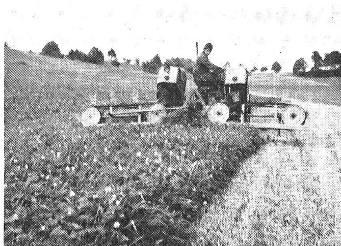
Abb.2: Dieses Gerät ergibt von ca. 3.70 m Mähbreite eine einzige Mahd. Weil die beiden Balken einzeln leicht verdrehbar sind, ergibt sich trotz grosser Mähbreite eine gute Bodenanpassung. Das Gerät ist später für Frontantrieb gedacht.
