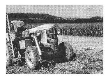
Abb. 1: Ein gebogenes Rohrstück wird aufklappbar am Vorderachsschenkel befestigt. Dieses praktische Steuergerät ist in einzelnen Gegenden stark verbreitet, in anderen Gegenden eigenartigerweise fast unbekannt.
