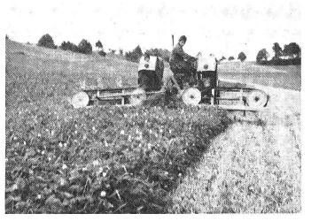
Abb. 2: Dieses Gerät ergibt von ca. 3.70 m Mähbreite eine einzige Mahd. Weil die beiden Balken einzeln leicht verdrehbar sind, ergibt sich trotz grosser Mähbreite eine gute Bodenanpassung. Das Gerät ist später für Frontantrieb gedacht.
