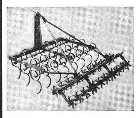
▲ Kultureggen mit Einwalzen- oder Doppelkrümler, Draht- oder Spitzzahnwalzen, verschiedene Walzen-Durchmesser, Arbeitsbreiten: 2,2 m, 2,55 m, 2,8 m, 3,1 m, 3,3 m.
