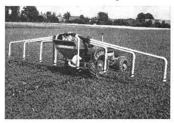
Dieser moderne, pneumatische Düngerstreuer streut alle ge-körnten Dünger mit einer unerreichten Genauigkeit von 4—6% in Breiten von 10 und 12 m bei hoher Fahrgeschwindigkeit. Die Streumenge lässt sich genau regeln zwischen 85 und 1500 kg/ha. Kombinierbar als Breit- und Reihenstreuer besonders geeignet für Maiskulturen. Der ideale Düngerstreuer für Grossbetriebe und für Genossenschaften.
