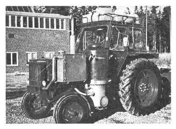
Abb. 1: Ein moderner mit einer Holzgasanlage ausgerüsteter Dieseltraktor.
