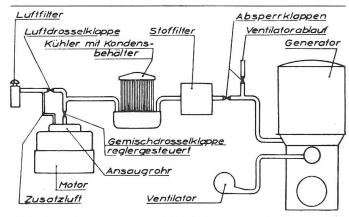
Abb. 2: Schema einer DHG-Anlage für Traktor- oder Lastwagen-Dieselmotoren.
