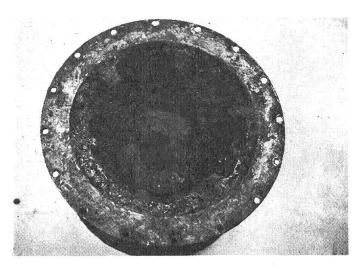
Abb. 5: Detailansicht des Herdes mit der Herddüse in der Mitte und den sechs Primärluftdüsen am oberen Rand.
