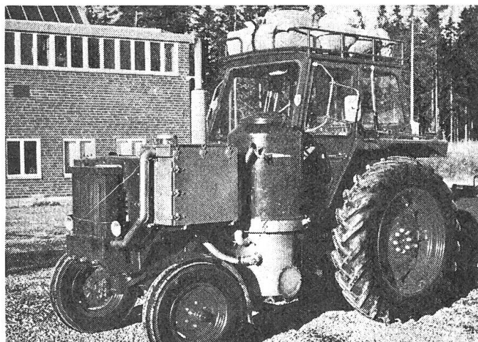
Abb. 1: Ein moderner mit einer Holzgasanlage ausgerüsteter Dieseltraktor.
