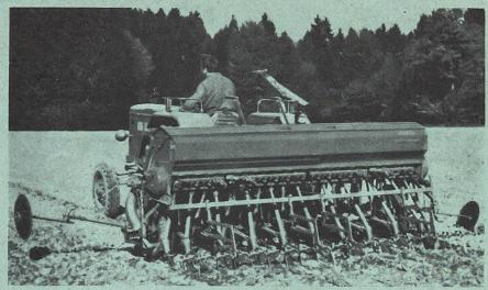
mit Normal- oder Scheibenscharen, beidseitigem Antrieb, Saatauslauf nach vorne, Pendelrührwerk (Möglichkeit für Raygraseinsätze) usw.
