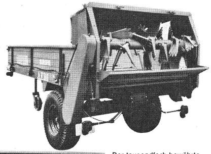
Der tausendfach bewährte Kemper-Frässtreuer mit der feinen Fräsarbeit für Wiesendüngung. Streubreite einstellbar von 2,5 bis 8 m.
