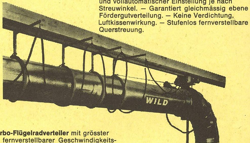
Super-Turbo-Flügelradverteiler mit grösster stufenlos fernverstellbarer Geschwindigkeitsregulierung für Querstreuung. — Vollständig geschlossenes Antriebssystem. — Robuste Konstruktion. — Kleinstes Einbaumaß ohne Wanddurchbrüche möglich.
