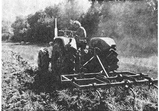
Abb. 6: Vor der Frässaat soll das Feld in der Regel mit einem Grubber tief gelockert werden, um dadurch die Bildung einer Schmierfläche zu verhindern.
