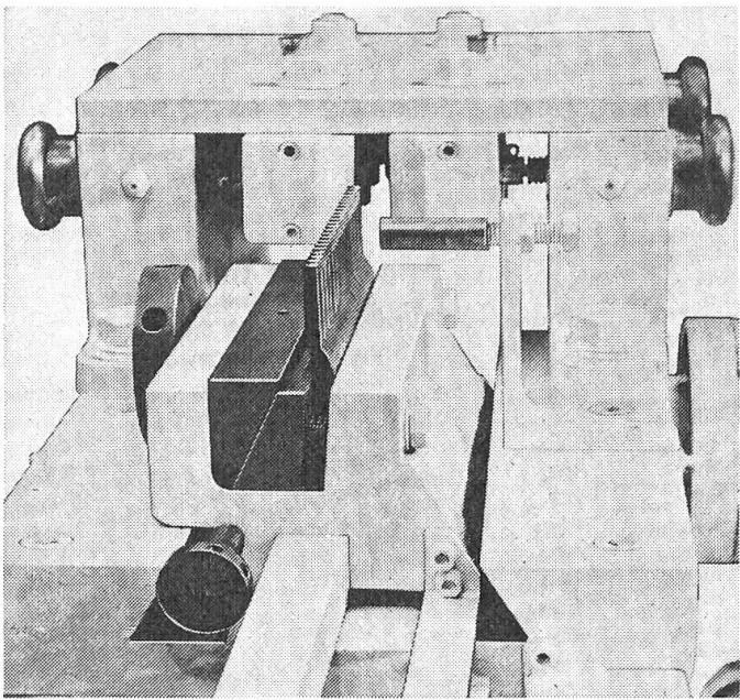
Walzen durchläuft, vier auf der einen Seite des Messers und drei auf der anderen Seite. Sobald das Messer die Walzen durchlaufen hat, wird es geprüft und ausgespannt, oder man lässt es die Walzen in entgegengesetzter Richtung noch einmal durchlaufen. Die Steuerung des Schlittens erfolgt mit einem Anlasser/Umkehrschalter ohne Strombegrenzungswiderstand in Verbindung mit zwei Endschaltern.
