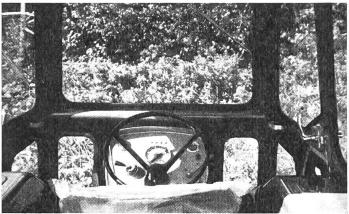
Sicherheitsrahmen oder das Sicherheitsverdeck kaufen und später zur Kabine ergänzen. Sekura-Sicherheitskabinen sind zur Zeit anbaufertig lieferbar für Deutz, Ford, IHC, Massey-Ferguson, John Deere und Same. Für alle andern Traktor-Marken führt die Firma ein Standard-Modell.
