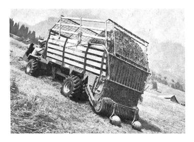
kann mit 4 Messern ausgerüstet werden, der vor- und rückwärtslaufende Kratzboden sowie der Pic-up Aufzug werden motorhydraulisch betätigt. Das Aufsatteln auf die Grundfahrzeuge RAPID ALLTRAC 1350 und 1750 geschieht werkzeuglos und ohne Schwerarbeit.
