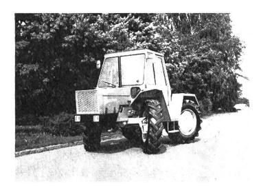
lastverteilung für schwere Zugarbeiten sowie schweren Geräteeinsatz. Die Aufnahme aller Anbaugeräte, ob gezogen oder geschoben, auf der vom Fahrzeug selbst nicht belasteten Fahrzeugseite, ermöglicht völlig neue landtechnische Einsatz- und Arbeitsmethoden.
