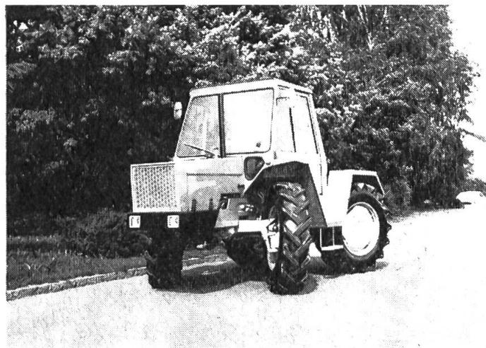
lastverteilung für schwere Zugarbeiten sowie schweren Geräteneinsatz. Die Aufnahme aller Anbaugeräte, ob gezogen oder geschoben, auf der vom Fahrzeug selbst nicht belasteten Fahrzeugseite, ermöglicht völlig neue landtechnische Einsatz- und Arbeitsmethoden.
