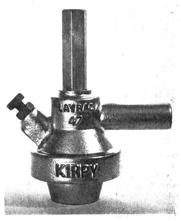
stärke hat die Pumpe eine Leistung von 150-350 I/min. Mit einem Spezial-Plasticschlauch wird KIRPY mit dem Vakuum-Kessel der Melkanlage verbunden und schon ist die Melkanlage wieder in Betrieb. Die gleiche Pumpe kann auch als Flüssigkeitspumpe eingesetzt werden.
