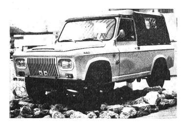
fügt über einen 2,5 I 4-Zylinder-Motor mit einer Leistung von 80 DIN-PS. Der Allradantrieb, das voll synchronisierte 4-Gang-Getriebe mit entsprechenden Geländegängen stempelt den ARO zum Luxusfahrzeug und zur Arbeitsmaschine gleichermassen und dürfte deshalb, nebst vielen andern Berufsschichten, auch für den Landwirt von grossem Interesse sein.
