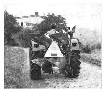
Abb. 1: Der nach BAV vorgeschriebene Signalkörper.
