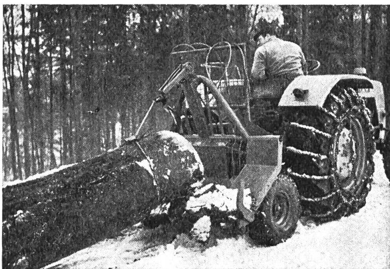
An Ihrem Traktor montiert, vervielfacht er die Tagesleistung und macht sich schnell bezahlt. Sicher im Betrieb. Kann in einigen Minuten an jeden Traktor im Dreipunkt angebaut werden und erspart Ihnen die Anschaffung eines Spezialfahrzeugs. Ausgerüstet mit Steyr-Winde. Zugkraft 4000 kg. Mit 75 Meter Drahtseil  $\phi$  12 mm.
