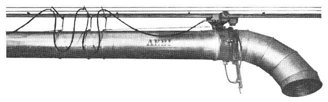
Den vollautomatischen Flächenverteiler Fe-Gu mit Elektro-Antrieb, passend zu Rohr Ø 400 und 500 mm, für Stockflächen bis 7 m Länge und 12 m Breite.
