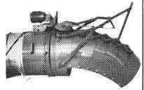
Profitieren Sie von unserer mehr als 20 jährigen Erfahrung bei der Installation solcher Anlagen. Nur der Fachmann kann beurteilen, welches System sich in Ihrer Scheune am besten eignet. Den automatischen Silo-Verteiler AEBI-Aeromatic, motorlos, luftgetrieben. Für Silos bis 5 m Ø, passend zu Rohrdurchmesser 250, 310, 380 und 400 mm.
