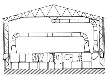
Schnitt, Ansicht Klimaaggregat
