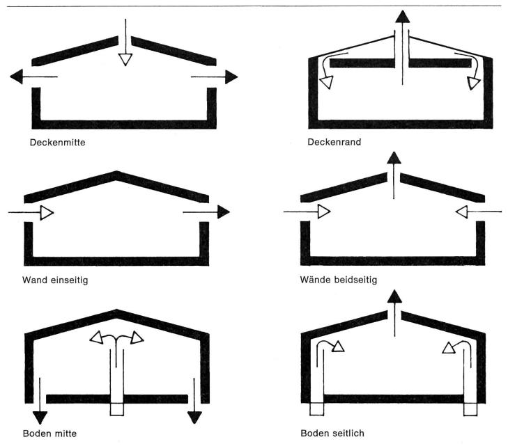
Abb. 1: Anordnung der grundsätzlich möglichen Lufteinlässe bei der Stallüftung.
